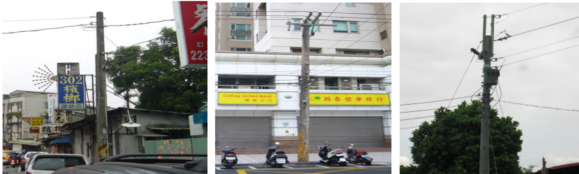
圖 2-3 電桿型支持物
